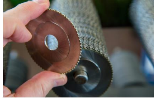
Dairesel testere bıçağındaki dişlerin bilenmesi için Alesa kendi makinasını geliştirdi.
